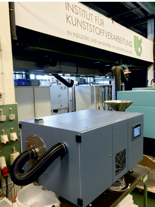
Bild 4. Im Technikum des IKV werden sowohl die polymerphysikalischen Zusammenhänge des IRD-Verfahrens untersucht als auch Ansätze zur Optimierung des Aufschmelzprozesses in der Spritzgießmaschine. © B.I.R.D Machinery
